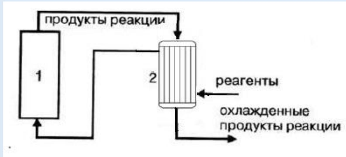
. 1 – реактор; 2 – теплообменник.
